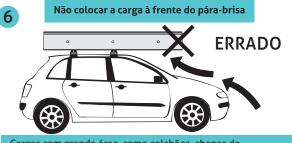
Cargas com grande área, como colchões, chapas de compensado, MDF, pranchas, longboard e stand up, etc... Deve-se tomar cuidado com a pressão aerodinâmica exercida à frente do pára-brisa, que levanta o conjunto voando fora. Para isto, devemos colocar cargas com grande área para trás, e não ultrapassar 80 km/h.
