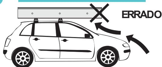
Cargas com grande área, como colchões, chapas de compensado, MDF, pranchas, longboard e stand up, etc... Deve-se tomar cuidado com a pressão aerodinâmica exercida à frente do pára-brisa, que levanta o conjunto voando fora. Para isto, devemos colocar cargas com grande área para trás, e não ultrapassar 80 km/h.
